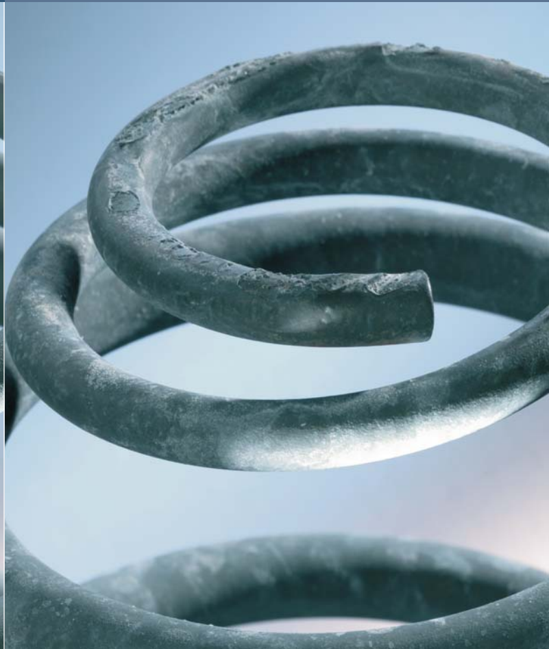
Après 400h de brouillard salin
