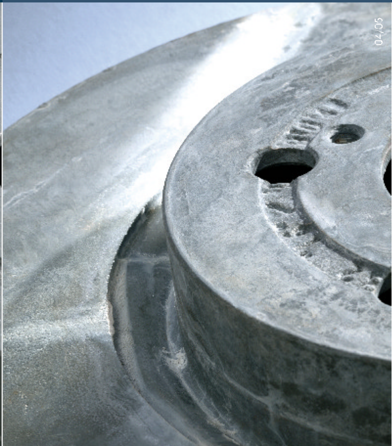
Nach einer Belastung von 500h im Salzsprühtest
